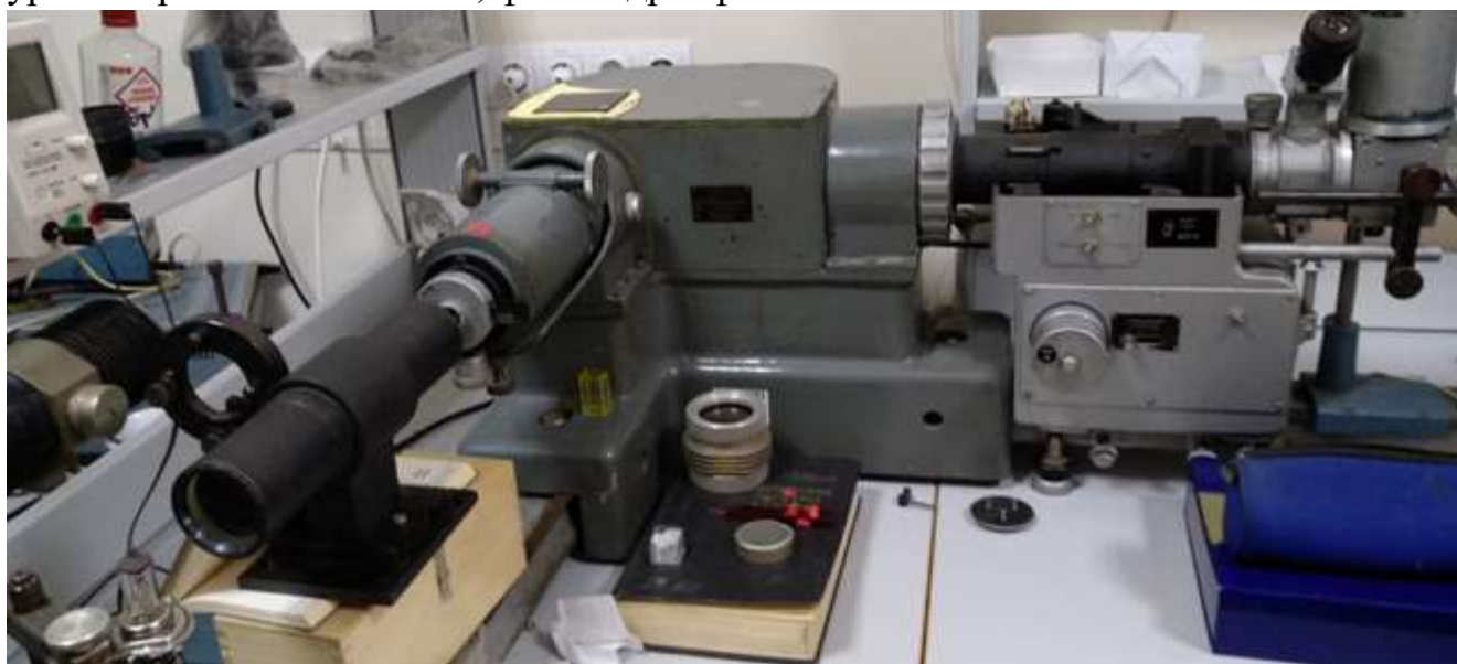
Рис. 2.15. ИКС-51 в обвязке с галогеновой лампой и фотоумножителем ФЭУ-82.
