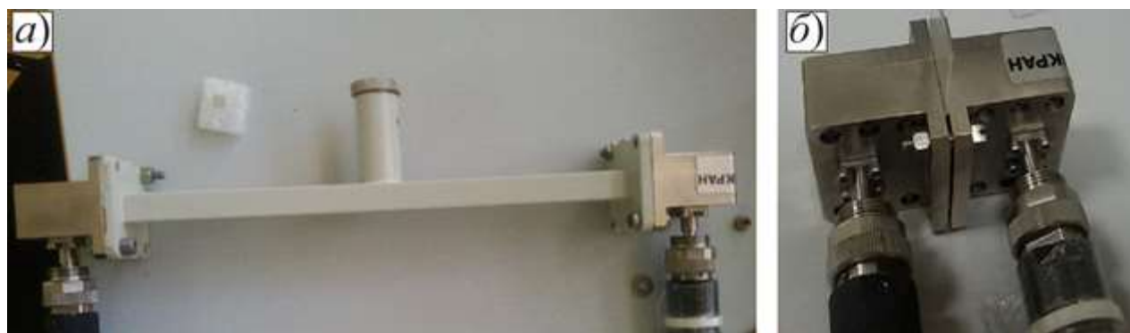
Рис. 2.8. Способы ввода образцов в рабочее пространство волноводов: а) вертикальное размещение; б) непосредственное размещение, при разборке волноводных секций.
