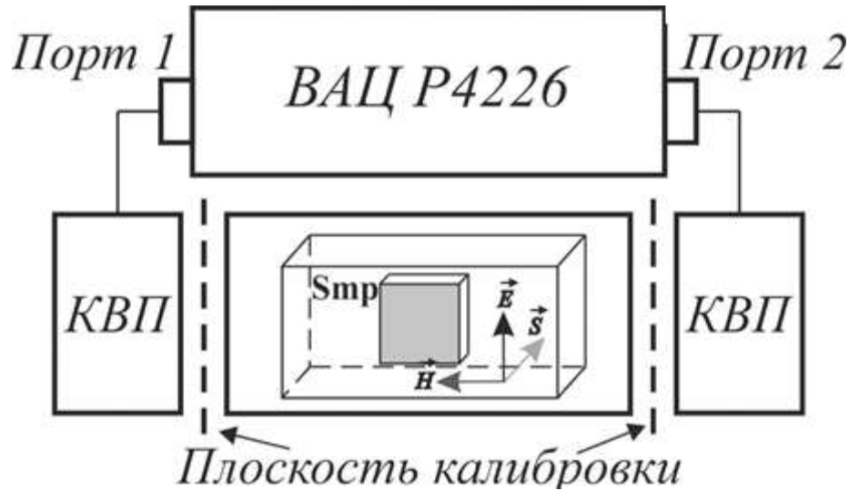
Рис. 2.5. Блок-схема измерительной установки на 8,1 – 12,2 ГГц на базе анализатора цепей P4226 компании «Микран».
