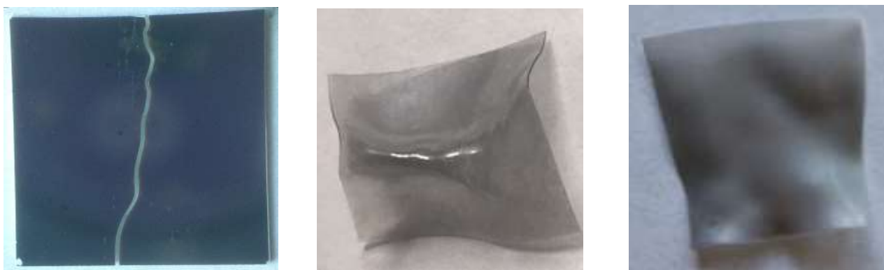
Рис. 3.49. Раскол металлодиэлектрических образцов на ситалле, слева, деформация на лавсане, середина, фторопласте, справа.
