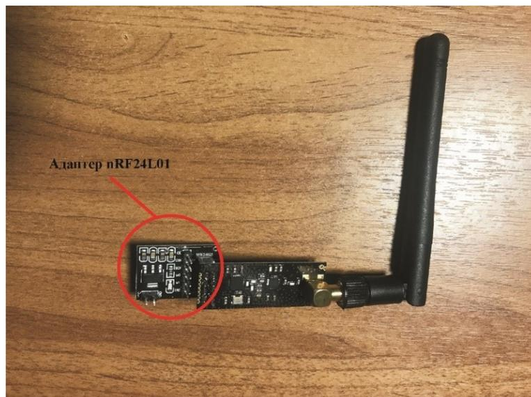
Рисунок А.5 Подключение адаптера nRF24L01 к модулю nRF24L01+PA+LNA
