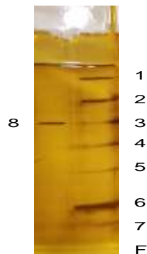
Рис.69. Электрофорез в ПААГ в присутствии Ds-Na очищенной гликолатоксидазы из хлореллы (8). Белки-маркеры молекулярной массы (кДа): 1 – \beta -галактозидаза E. Coli (116); 2 – бычий сывороточный альбумин (66,2); 3 – овальбумин (45,0); 4 – лактатдегидрогеназа сердечной мышцы (35,0); 5 – Bsp391 E.coli (25,0); 6 – \beta -лактоглобулин (18,4); 7 – лизоцим яичного белка (14,4).
