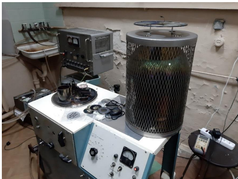
Рисунок 2.21. Установка магнетронного распыления
