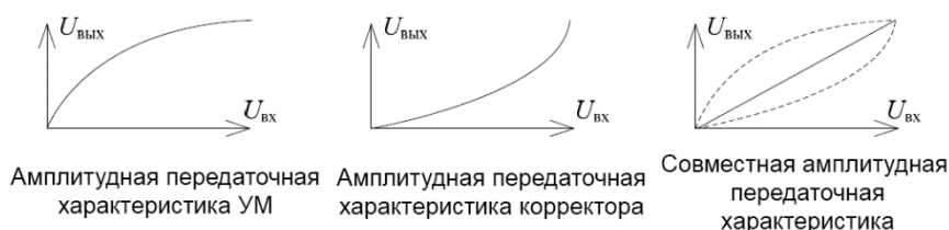
Рис.6 Принцип метода предискажений
