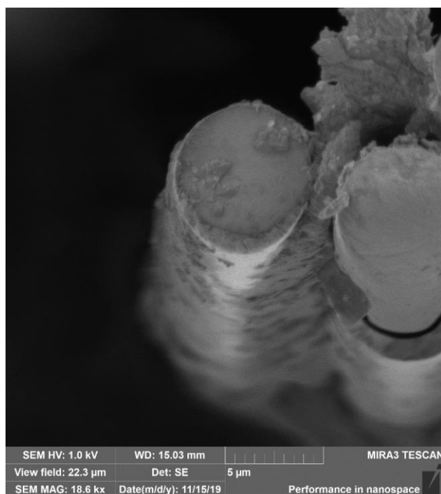
Рис. 2.16 - РЭМ микрофотография сечения стеклоткани с пленкой нанокompозита
