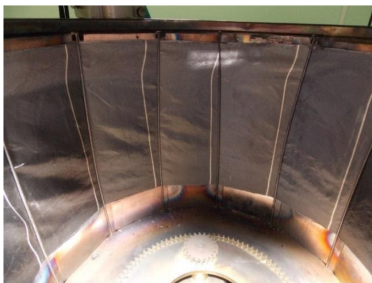
Рис. 2.14 – Крепление стеклоткани в напылительной камере
