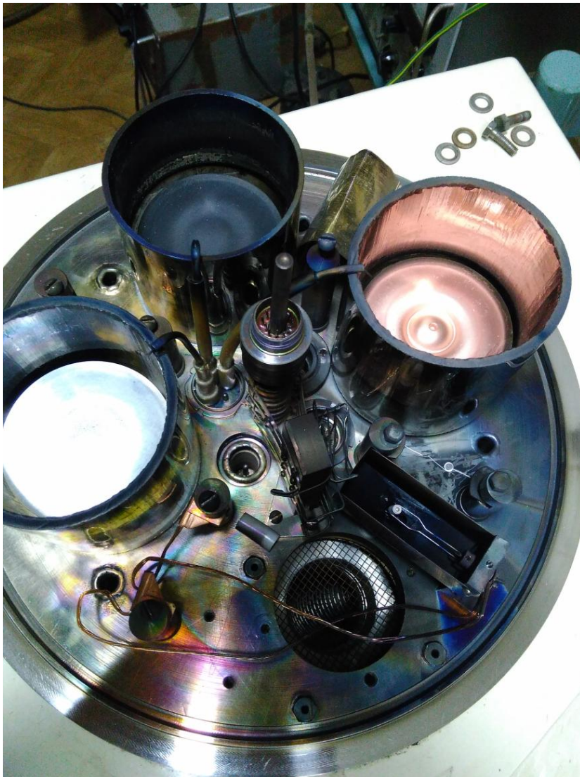
Рис.12. Универсальная вакуумная установка для термического и магнетронного нанесения тонких металлических слоев
