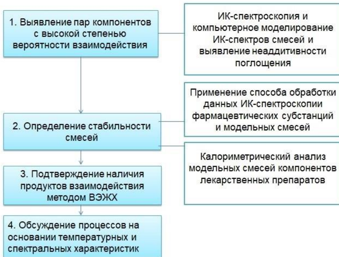
Рис. 5.4. Алгоритм анализа состояния многокомпонентных систем применительно к фармацевтическим субстанциям
