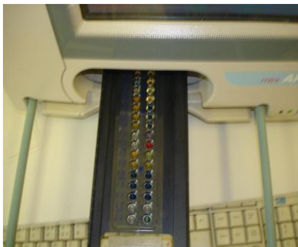
Рис.4. Баканализатор марки bio Merieux серии mini API
