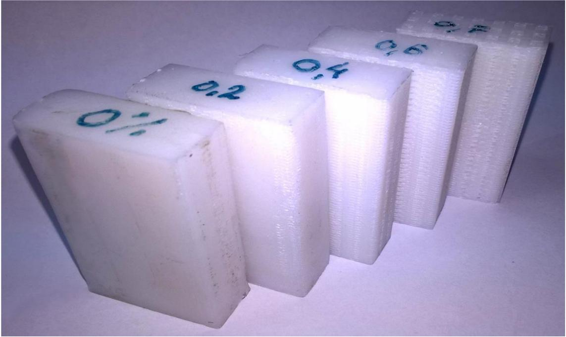
Рисунок 3.2. Фотография образцов диэлектрического материала с различным коэффициентом заполнения ( $S = 0$ ;  $S = 0.2$ ;  $S = 0.4$ ;  $S = 0.6$ ;  $S = 0.7$  слева направо).
