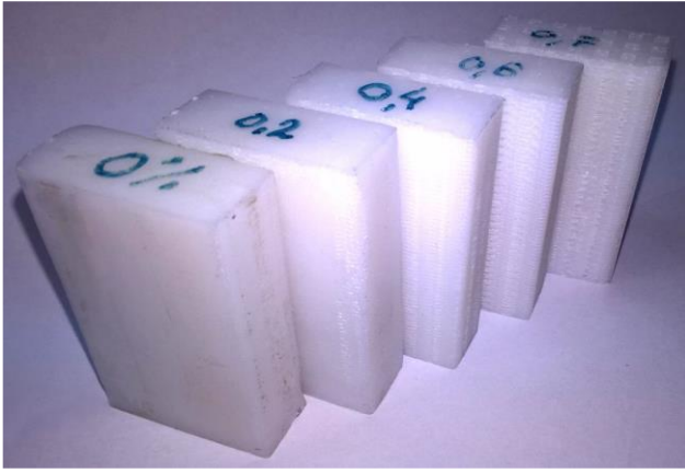
Рисунок 11 – Фотография образцов диэлектрического материала с различным коэффициентом заполнения.
