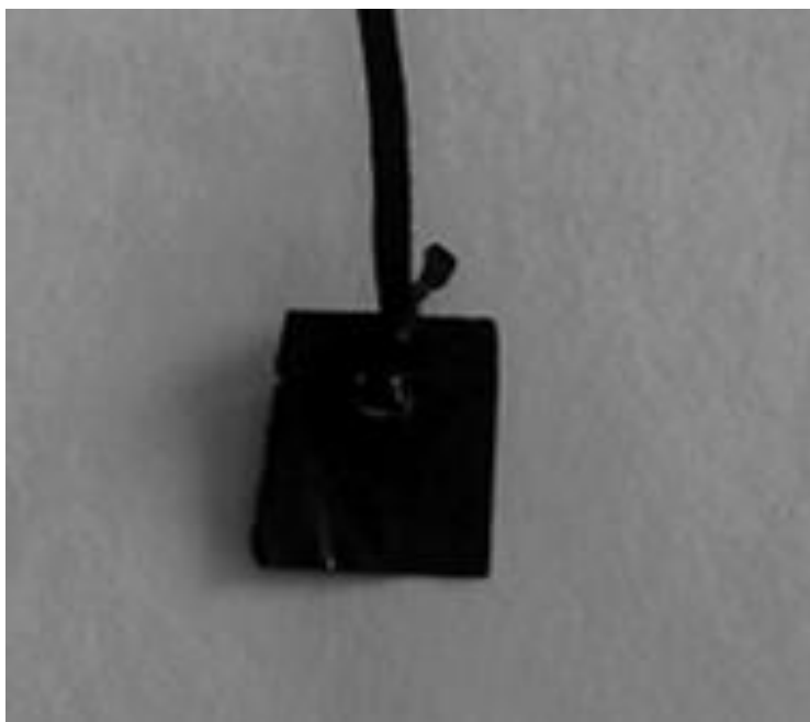
Рис. 4.20. Изображения внешнего вида ( a ) и СЭМ ( б ) поверхности Pt- электрода после поляризации в 1.0 М растворе H_2SO_4 в присутствии DMCO_2 при E=-0.4 В.
