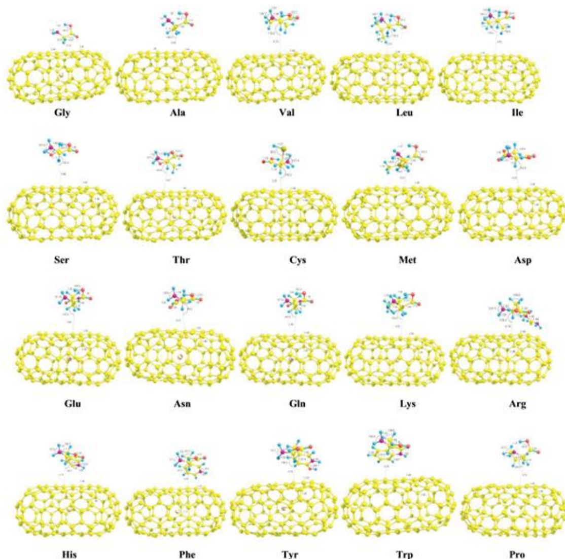
Рис. 1.8. Расположение аминокислот на УНТ (5,5)
