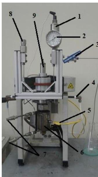
Рисунок 2.1 — Схема реактора (автоклава) Autoclave Engineers Parker (USA). 1) датчик давления; 2) манометр; 3) игольчатый кран для сброса избыточного давления; 4) подвод охлаждающей жидкости к магнитному приводу мешалки; 5) датчик температуры (термопара К-типа); 6) реакционный сосуд в нагревательном кожухе; 7) патрубки для подачи охлаждающей жидкости реактора; 8) прорывная мембрана для аварийного сброса давления; 9) привод мешалки.
