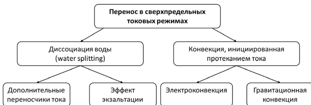
Рисунок 1.5 – Схема основных механизмов переноса, обусловленных развитием КП в сверхпредельных токовых режимах (адаптировано из [65])
