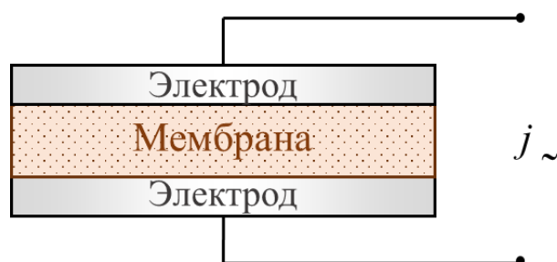
Рисунок 2.3. Схема ячейки для измерения сопротивления мембран контактным методом. Адаптировано из [1]
