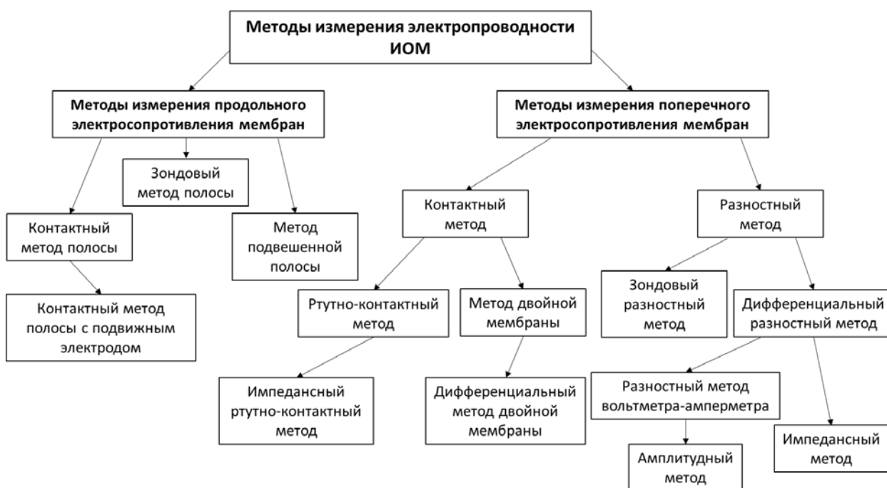
Рисунок 2.2. Схема методов измерения удельной электропроводности ИОМ.
