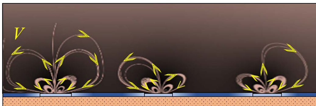
Рисунок 1.10. Схема распределения электроконвективных потоков (направление показано стрелками) вблизи поверхности ИОМ при наличии участков с разной степенью гидрофобности: темно-синие заштрихованные участки – гидрофильные зоны; светло-синие – гидрофобные
