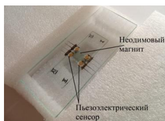
Рисунок 1 – Ячейка детектирования пьезоэлектрического сенсора на основе МУНК
