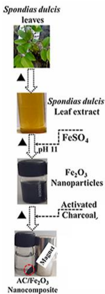
Рисунок 1.6. Схема синтез магнитного нанокompозита AC/Fe 2 O 3
