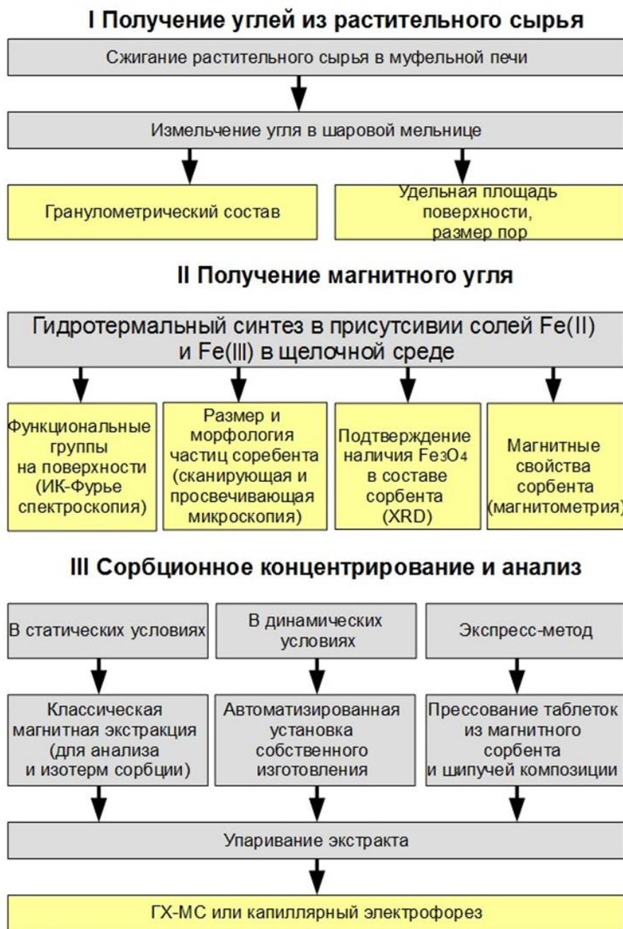
Рисунок 2.1. Схема получения сорбентов и их применение для сорбционного концентрирования
