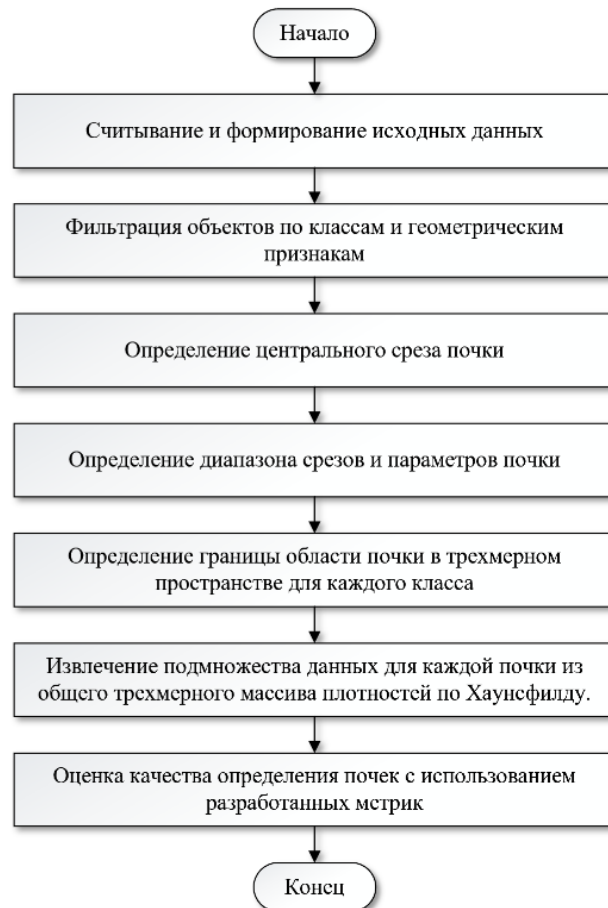
Рисунок 3.1 - Блок-схема алгоритма трехмерной сборки объектов почек
