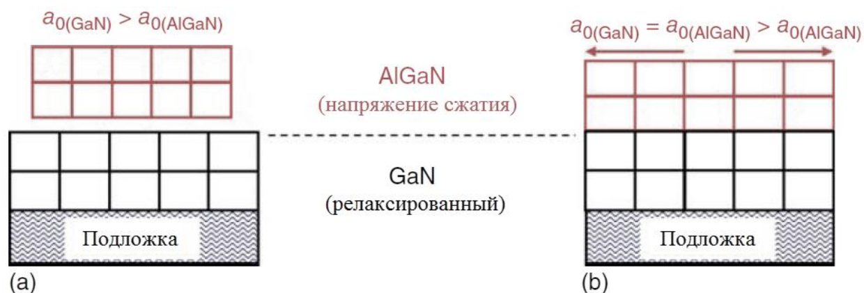
Рисунок 1.14. Схематичная структура изолированных кристаллов \text{AlGaN} и \text{GaN} (a) и сформированной \text{AlGaN}/\text{GaN} гетероструктуры (b) [41].
