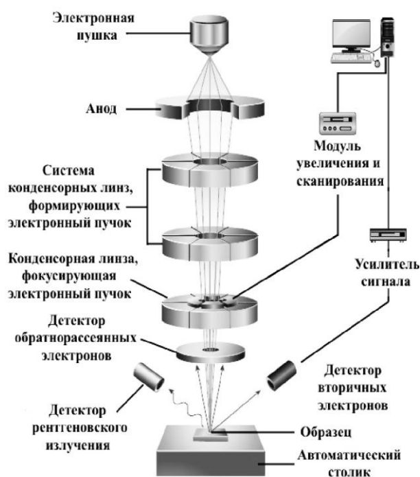
Рисунок 2.2. Принципиальная схема растрового электронного микроскопа (слева). Растровый электронный микроскоп JSM-6380LV JEOL (справа) [122].
