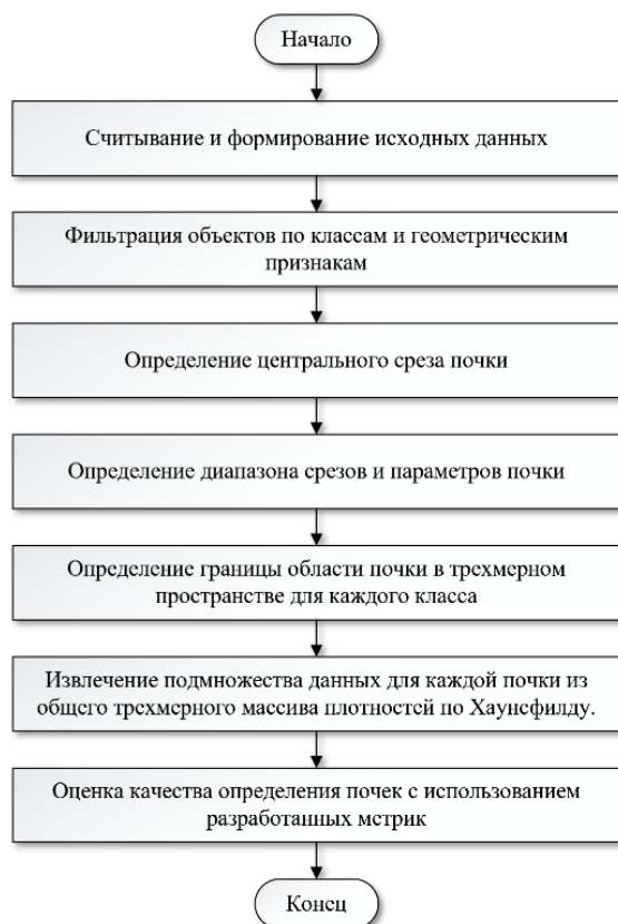
Рис. 6. Блок-схема алгоритма трехмерной сборки объектов почек
