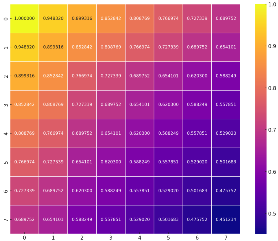
Рисунок 2.7 – Тепловая карта пространственного коэффициента корреляции. Расчет приводится для пикселя в координате (0, 0) и для патча размером 8x8.
