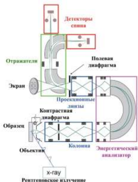
Рисунок 1.31 – Конструкция микроскопа PEEM и его основные элементы
