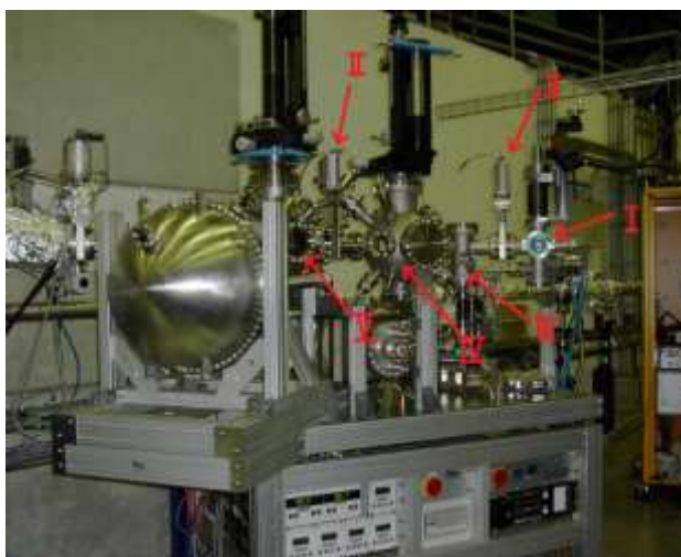
Рисунок 2.3 – I – подготовительная камера; II – отсекающие вакуумные затворы; III – «карусель» для передачи образцов между камерами; IV – подготовительная камера; V – экспериментальная камера
