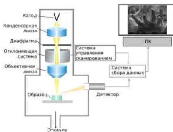
Рисунок 1.19 – Принципиальная схема устройства сканирующего электронного микроскопа
