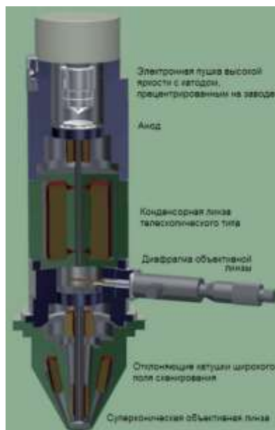
Рисунок 2.1 – Электронно-оптическая колонна растрового электронного микроскопа
