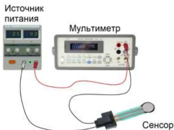
Рис. 2.2. Установка для определения антибиотиков в жидкостях амперометрическим сенсором
