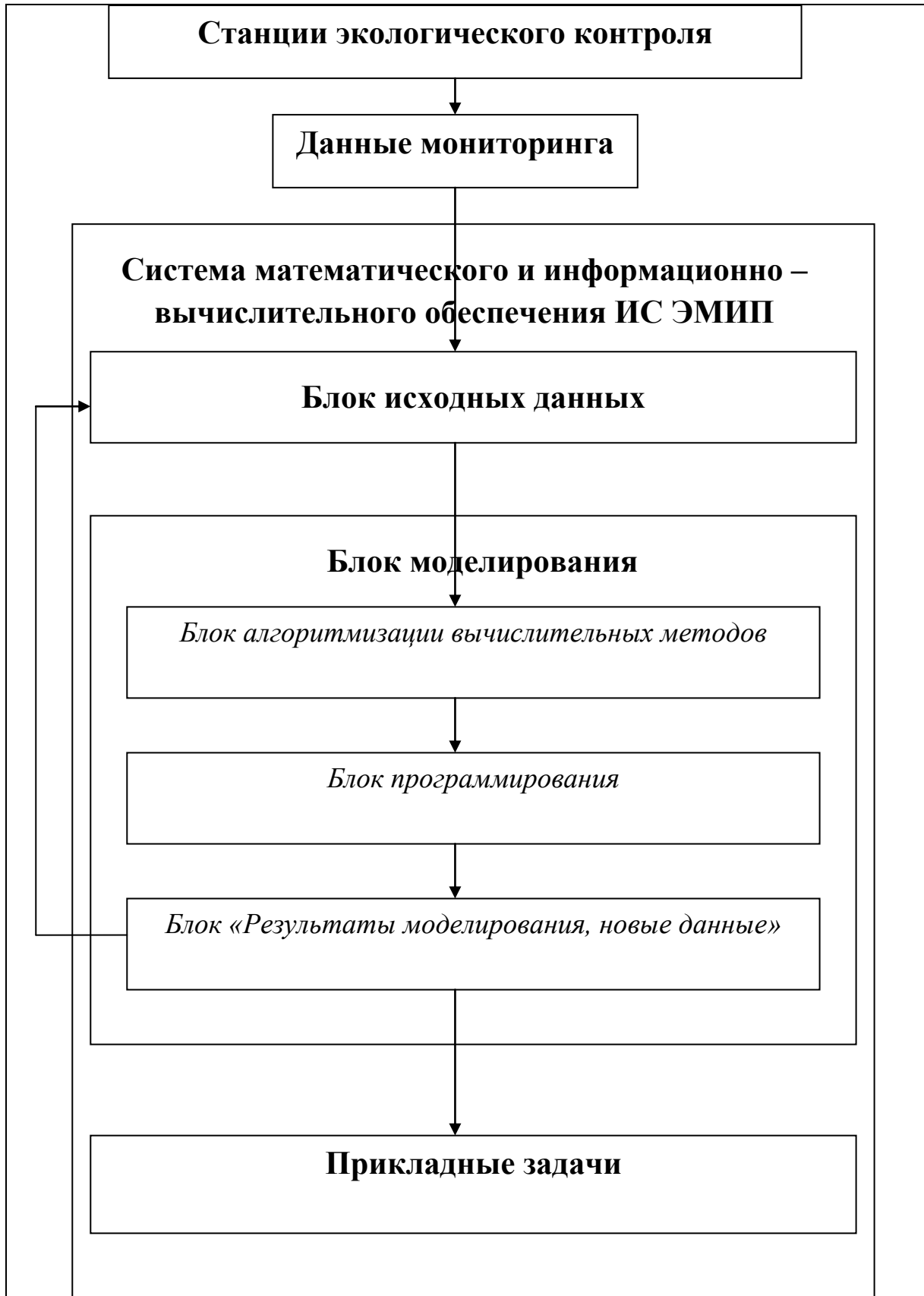
Рисунок 4.1 – Структурная схема системы компьютерного моделирования процессов переноса загрязняющих примесей в атмосфере
