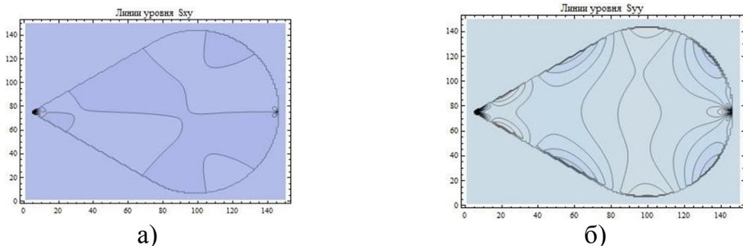
Рисунок 3 – Изолинии компонент тензора напряжений: а)  $\sigma_{xy}$ , б)  $\sigma_{yy}$
