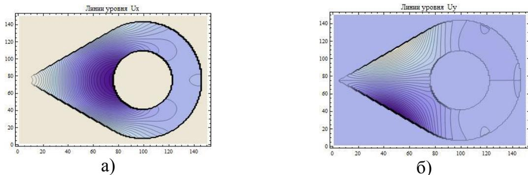
Рисунок 4 – Изолинии: а)– изолинии компоненты напряжения  $\sigma_x$ ; б) – изолинии компоненты напряжения  $\sigma_{xy}$ .
