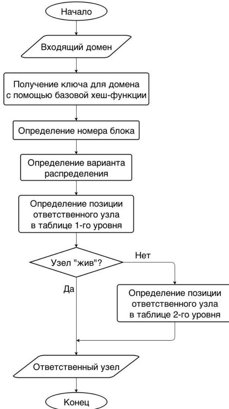
Рисунок 2.13 – Блок-схема алгоритма поиска ответственного узла с применением таблиц 1-го и 2-го уровней
