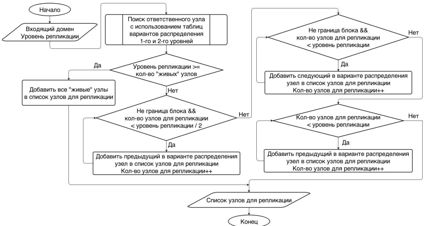
Рис. 5. Блок-схема алгоритма репликации на основе использования ближайших к ответственному узлу областей ответственности
