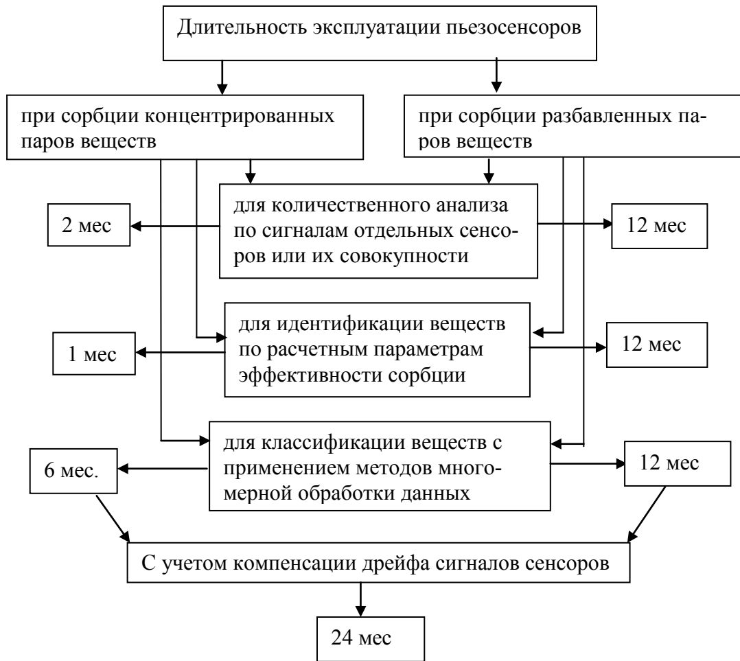
Рис. 3.16 Длительность эксплуатации пьезосенсоров при сорбции паров органических соединений
