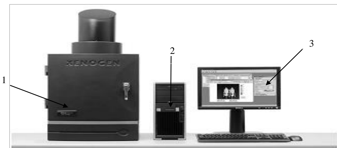
Рисунок 2.4 – Аппаратное устройство системы визуализации IVIS® Lumina II: 1 – камера визуализации, 2 – системный блок, 3 – монитор
