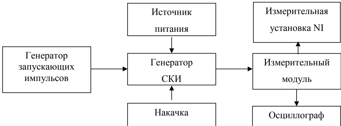
Рисунок 3.4 - Блок-схема экспериментального исследования.
