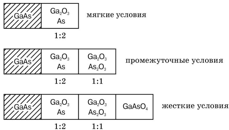
Рис. 1.1. Схематическое изображение фаз, образующихся при термическом оксидировании GaAs
