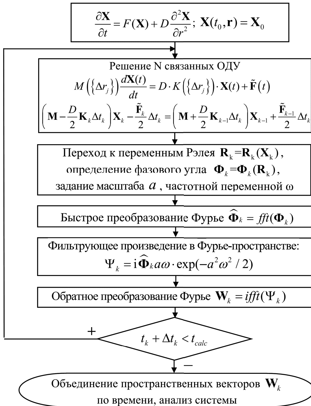
Рис. 3.1. Схема алгоритма численного исследования динамических систем на основе вейвлет-анализа
