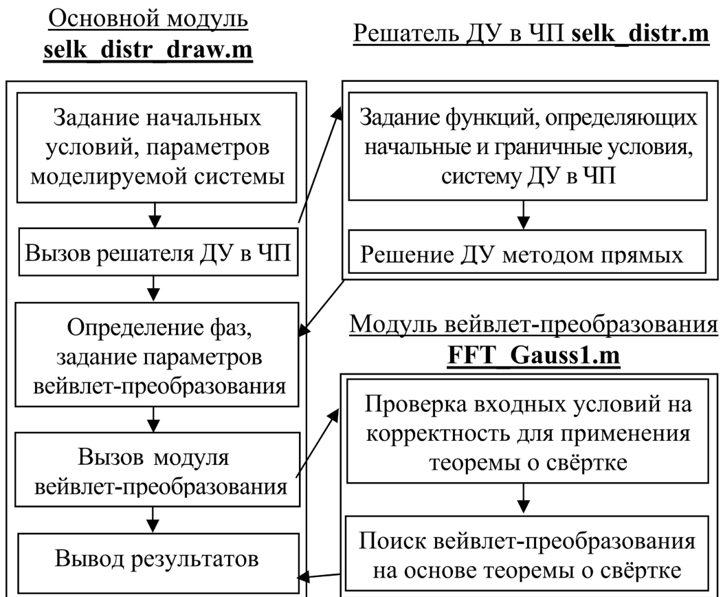
Рис. 3.2. Структурная схема комплекса программ на языке MATLAB практической реализации предложенного алгоритма
