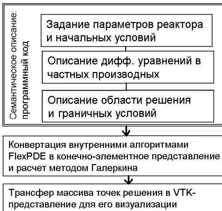
Рис. 2.2. Схема расчёта численного решения начально-краевой задачи (2.3)–(2.6) в среде FlexPDE
