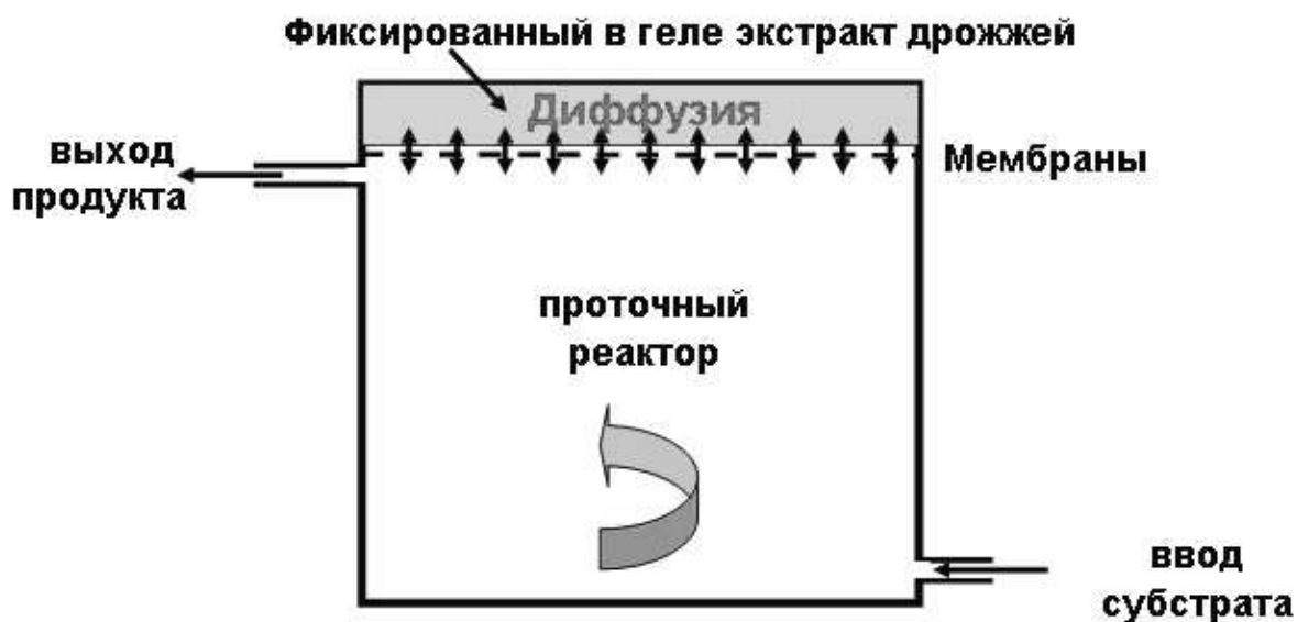
Рис. 1.3. Схематическое изображение открытого пространственного реактора. Нижняя часть реактора представляет собой проточный реактор, верхняя часть состоит из зафиксированного в геле экстракта дрожжей
