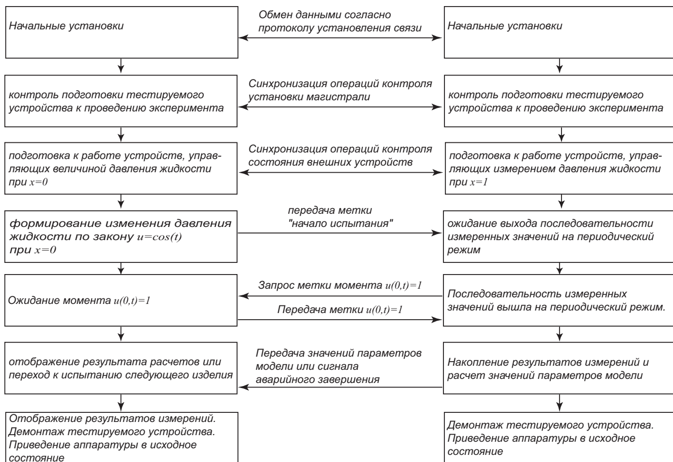
Рис 9. Блок схема процесса измерения параметров жидкость–проводящей магистрали
