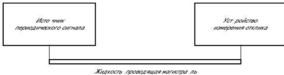
Рис 8. Схема разделения функции в комплексе измерительной аппаратуры
