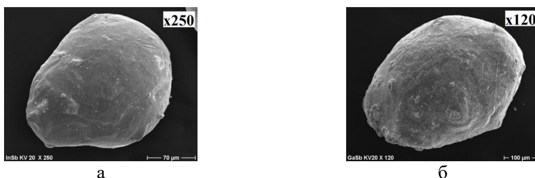
Рис.5.1. Внешний вид сфероидальных структур InSb, x250, 20 кВ (а) и GaSb, x120, 20 кВ (б)
