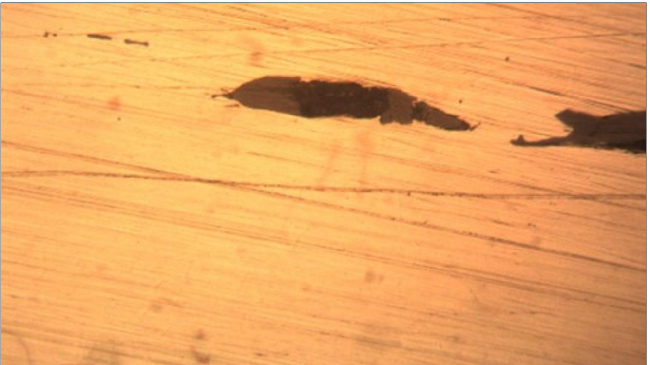
Рис. 37. Микроструктура образцов. Вид включений (x 100)
