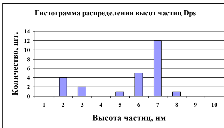
Рис. 27. (А) - пример АСМ-изображения нативного Dps (белая черта соответствует 100 нм); (В) - гистограмма распределения высот измеренных частиц белка
