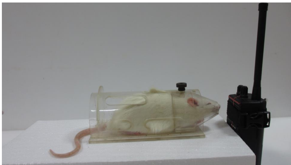
Рисунок 5.9. Размещение биологического объекта перед источником ЭМП.
