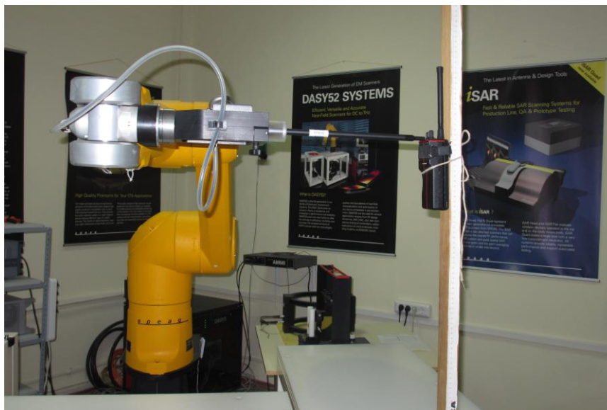
Рисунок 2.1. Измерения напряженности электрической составляющей ЭМП с помощью измерителя DASY 52 NEO.
