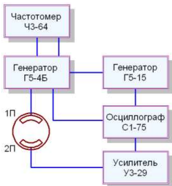
Рис. 2.5. Схема установки для измерения скорости звука
