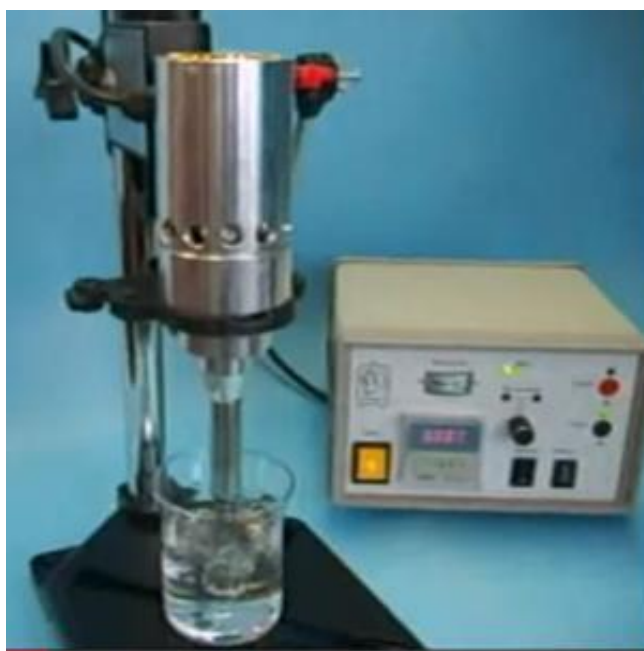
Рисунок 2.6 - Ультразвуковой диспергатор МЭФ91
