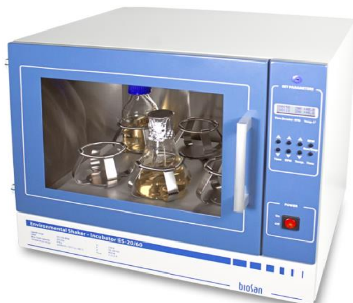
Рисунок 2.7 - Шейкер-инкубатор ES-20 для перемешивания водно-солевого раствора УНТ
