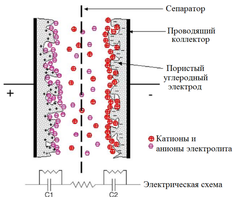
Рисунок 1.2 – Единичная ячейка электрохимического конденсатора [1]
