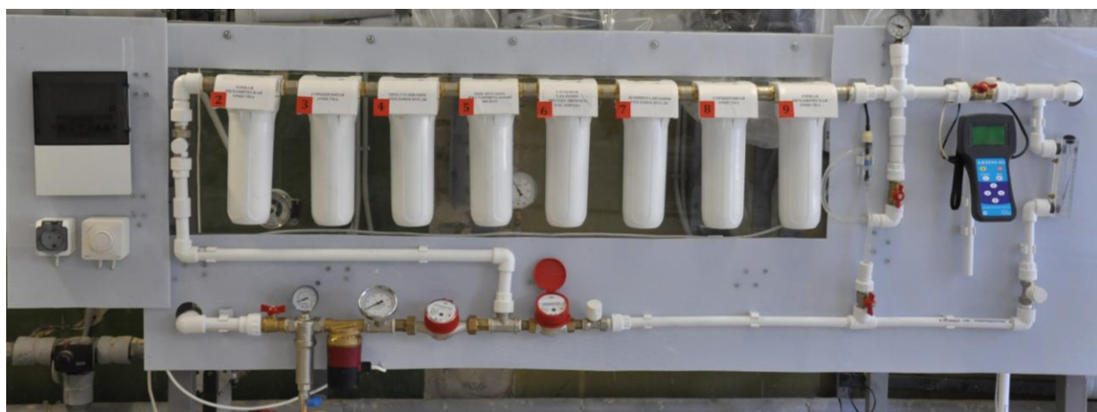
Рис.5.3. Испытательный стенд промышленной установки для глубокого обескислороживания воды.
