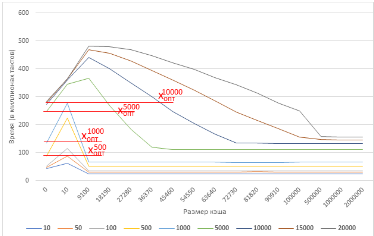
Рис. 4.5. Зависимость времени выполнения поиска в контейнере от размера кэша для различных \sigma при k=20 . Различными цветами изображены различные значения \sigma
