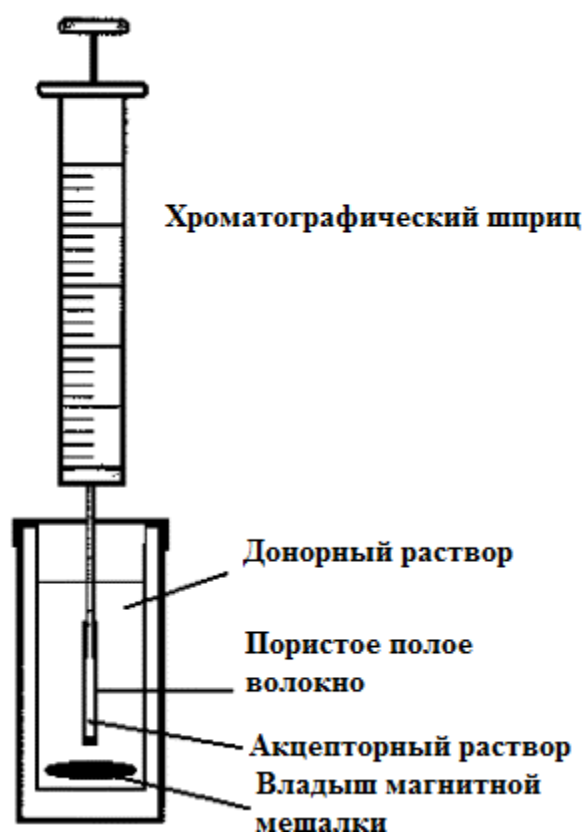
Рисунок 3 – Схема мембранной микроэкстракции с использованием полого волокна [75]
