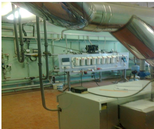
Рис. 4. Испытательный стенд производственной установки для обескислороживания воды в замкнутом контуре.
